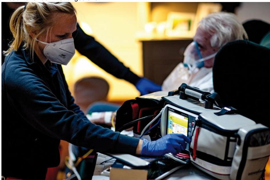
Der Monitor/Defibrillator »Meducore Standard<sup>2</sup>« besitzt zusätzliche neue Features wie einen kabellosen Drucker. Das 12-Kanal-EKG kann zudem mit nur wenigen Klicks über einen Wlan-Hotspot vorab an eine Klinik versendet werden (Bilder: Weinmann).
