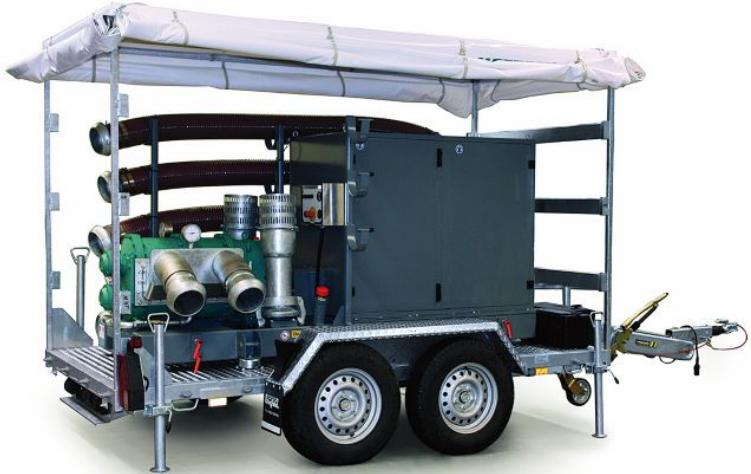
Eine »Tornado«-Drehkolbenpumpe mobil auf einem Anhänger für den flexiblen Einsatzzweck (Bild: Netzs).
