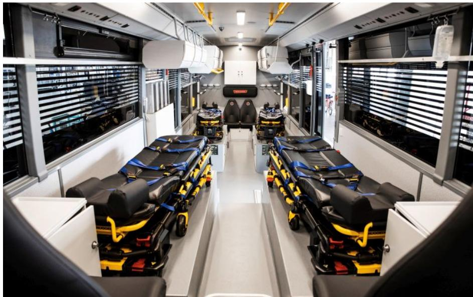
Der Niederflurbus ist in seiner neuen Funktion als G-ITW mit vier Intensivplätzen ausgerüstet.
