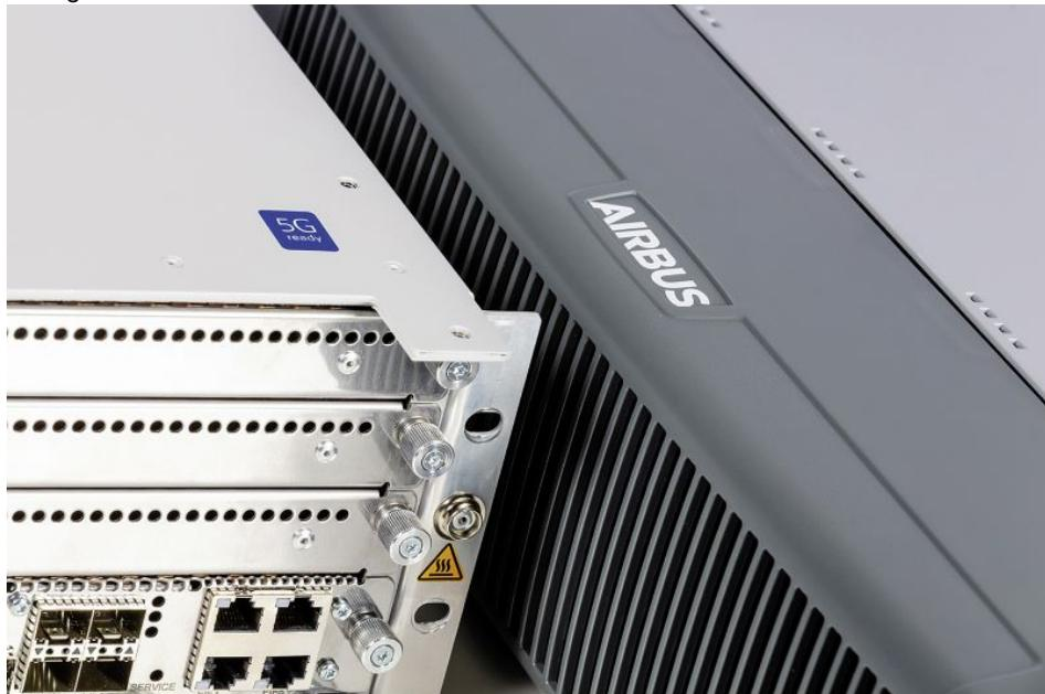
TB4 ist eine kompakte Basisstation der neuen Generation, die sowohl Tetra- als auch 4G-/5G-Zugriff unterstützt (Bild: Airbus).
