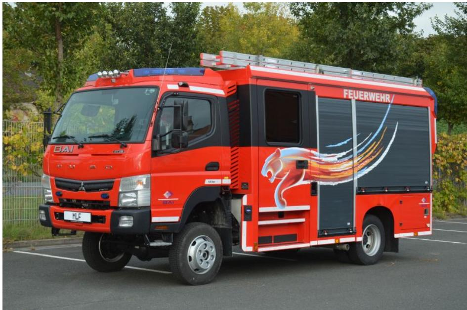
Mit dem Fuso Canter 6 C 18 (4x4) zeigt BAI, wie ein kompaktes und trotzdem geräumiges MLF mit Allradantrieb unter 7,5 Tonnen aussehen kann (Bilder: Holger Bahlmann).
