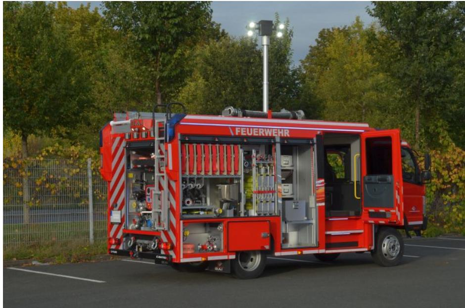
Eine LED-Umfeldbeleuchtung sowie der elektropneumatisch ausfahr- und drehbare Lichtmast machen die Nacht zum Tage.
