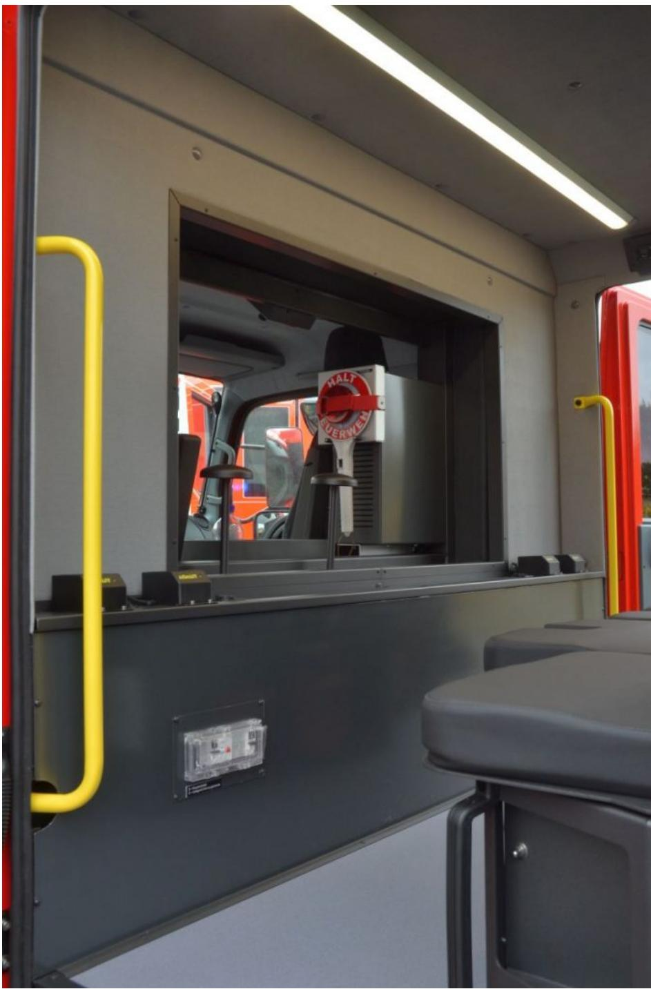
Eine große Öffnung zwischen Fahrer- und Mannschaftsraum ermöglicht eine gute Kommunikation innerhalb der sechsköpfigen Besatzung.
