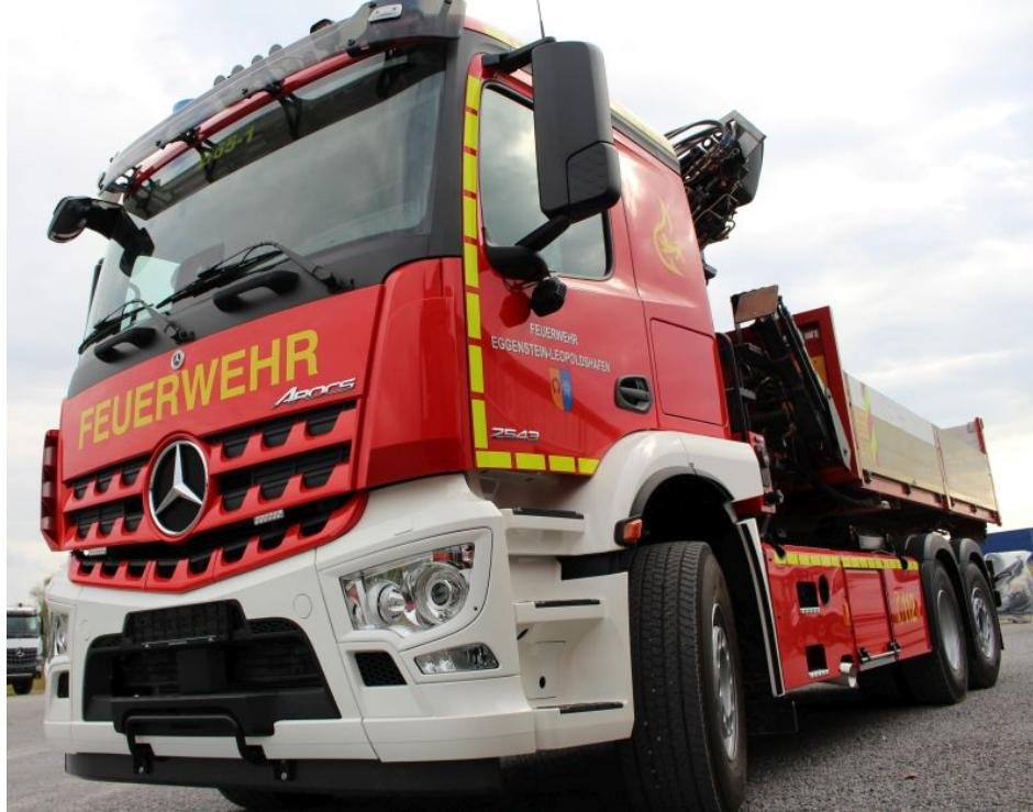
Ein Mercedes Arocs als Wechselladerfahrzeug mit Hakengerät für den Einsatz mit AB-Kranmulde.
