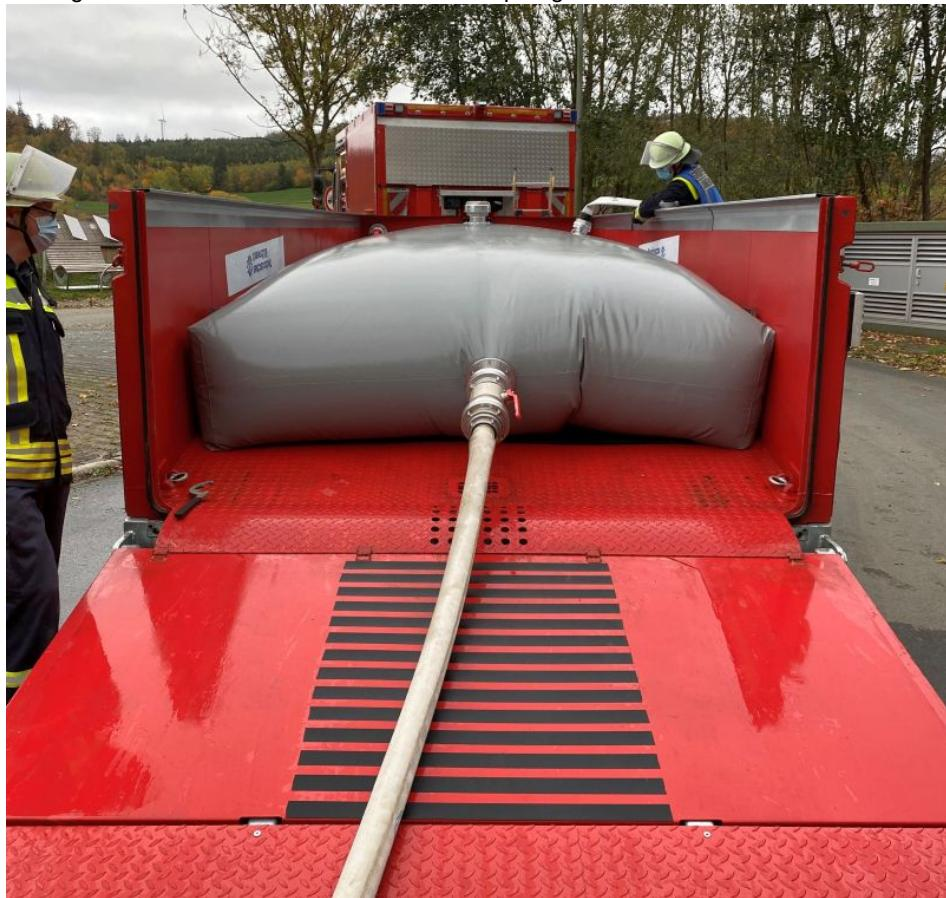
Ansicht des gefüllten Wassersacks im »Safety Trailer«. Abgebildet ist die Version mit 7000 l Fassungsvermögen (Bild: Paul Müller GmbH).
