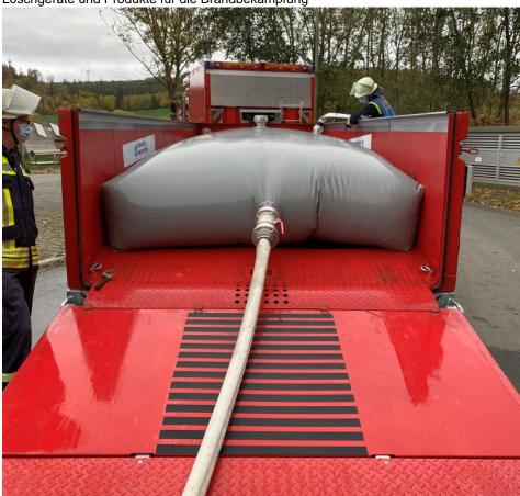
Ansicht des gefüllten Wassersacks im »Safety Trailer«. Abgebildet ist die Version mit 7000 I Fassungsvermögen (Bild: Paul Müller GmbH).
