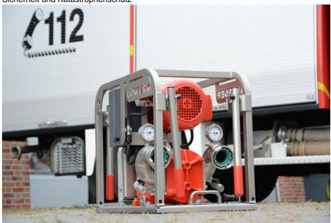
Die Gefahrgut-Umfüllpumpe wurde speziell für den Einsatz in unwegsamen Gelände oder innerhalb von Gebäuden entwickelt. Die feststoffunempfindliche Pumpe ist gemäß DIN 14427 gefertigt (Bild: Börger).
