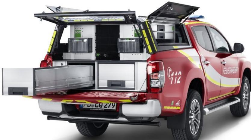
Die Seitenklappen des Hardtops ermöglichen das schnelle und einfache Zugreifen auf das Material in Schubladen (Bild: Bott).
