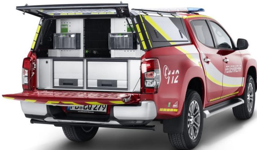
Die besonders leichte und robuste »bott vario3« Fahrzeugeinrichtung wurde exakt auf den ELW abgestimmt (Bild: Bott).
