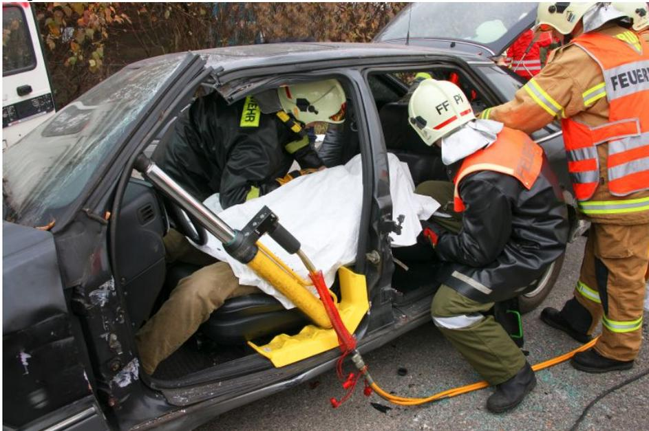
Die Datenblätter zum Fahrzeug-Modell erleichtern unter anderem das beschleunigte Retten und Bergen von Insassen mit schwerem Gerät, da z. B. die Position von Karosserieverstärkungen und hochfesten Stählen deutlich gekennzeichnet ist (Bild: DAT).
