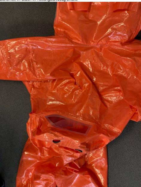
Rückseitiges Sichtfenster für die Warneinrichtungen der unter dem Anzug getragenen »3M/Scott ProFlow SC« (bzw. Asbestos) oder »Chemical 2F« Atemschutzgebläse (Bild: GM)
