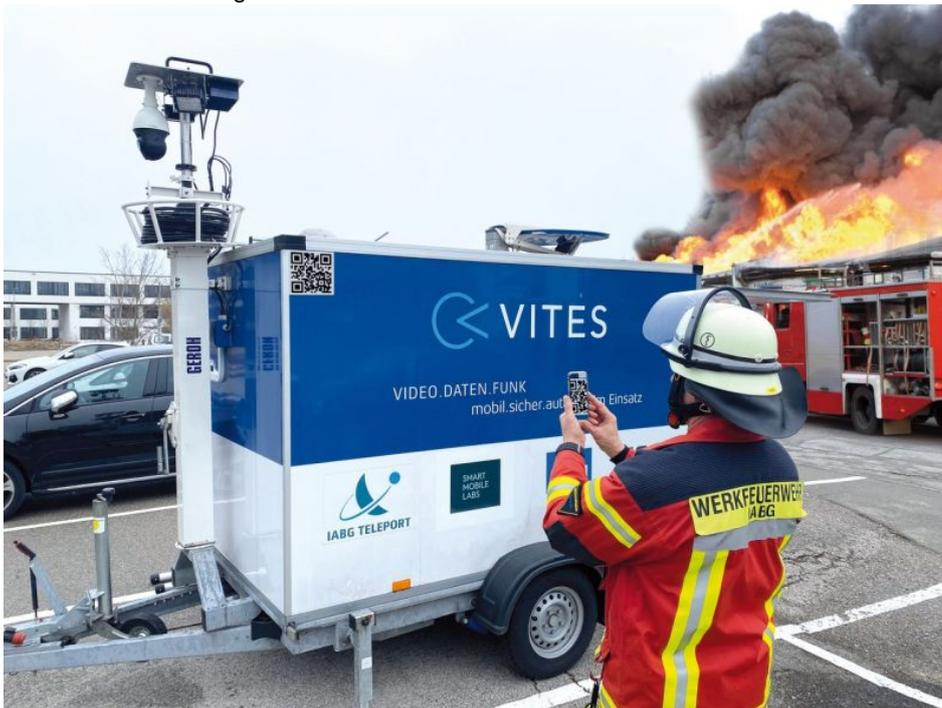
Das »vikomobil 2.0« ermöglicht verlegfähige Breitbandnetzwerke sowohl als mobile LTE-Funkzellen sowie als IP-Mesh-Funktechnik (Bild: Vites).
