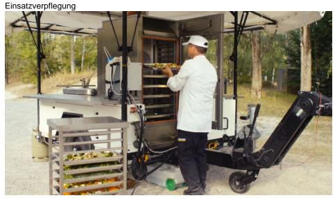
Schnelle Einsatzverpflegung mithilfe verschiedener Küchenmodule (links). Daneben eine mobile Aufbereitungsanlage »WTC 700« für Trinkwasser (Bilder: Kärcher Futuretech).
