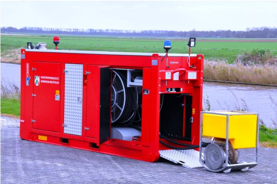
Das Hytrans-System ist ein mobiles Hochleistungswasserfördersystem für lange Wegstrecken (Bild: Hytrans).
