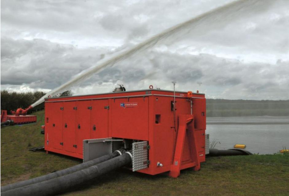
Ein Wasserfördersystem »HydroSub« als Abrollcontainer-Lösung mit Pumpeneinheit und 2000 m Schlauch (Bild: Hytrans).
