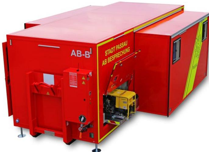
Die Erweiterungen sind innerhalb von 5 Minuten komplett ausgefahren und das System einsatzbereit (Bild: Jerg).
