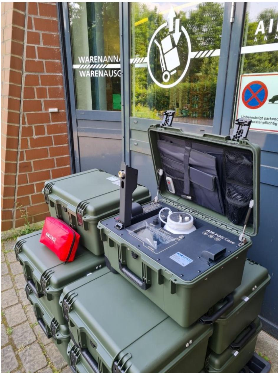
Das »AIR FOG Case« ist ein Desinfektionsgerät für Fahrzeug- und Gebäudeinnenräume. Es bekämpft mit einer Kaltvernebelung gefährliche Viren, Bakterien und Pilze (Bild: Airsense).
