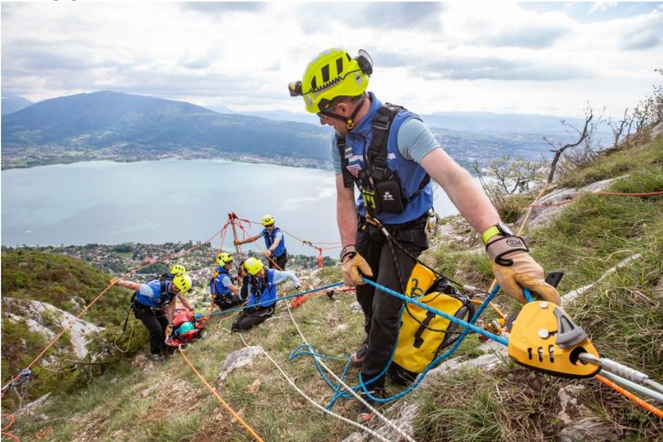
Der ergonomisch geformte Hebel und die integrierte Bremse des »Maestro« ermöglichen eine komfortable Steuerung des Abseilvorgangs (Bild: Petzl / Rettungsübung in Mont Veyrier, Annecy).
