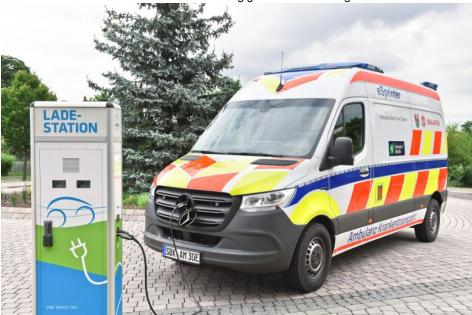
Die Batterie des »eSprinter« kann per Schnellladung in nur 20 min wieder von 10 auf 80 Prozent aufgeladen werden.
