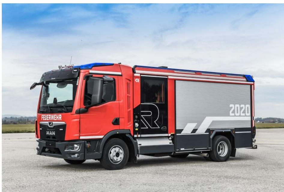
Der neue »TGL« mit »CC«-Kabine stellt die Grundlage für den Aufbau als Löschfahrzeug dar: in diesem Fall ein MAN »TGL 12.250 4x2 BB« mit 3,9-Meter-Radstand als Hilfeleistungslöschfahrzeug HLF 10 (Bild: MAN Truck & Bus SE).
