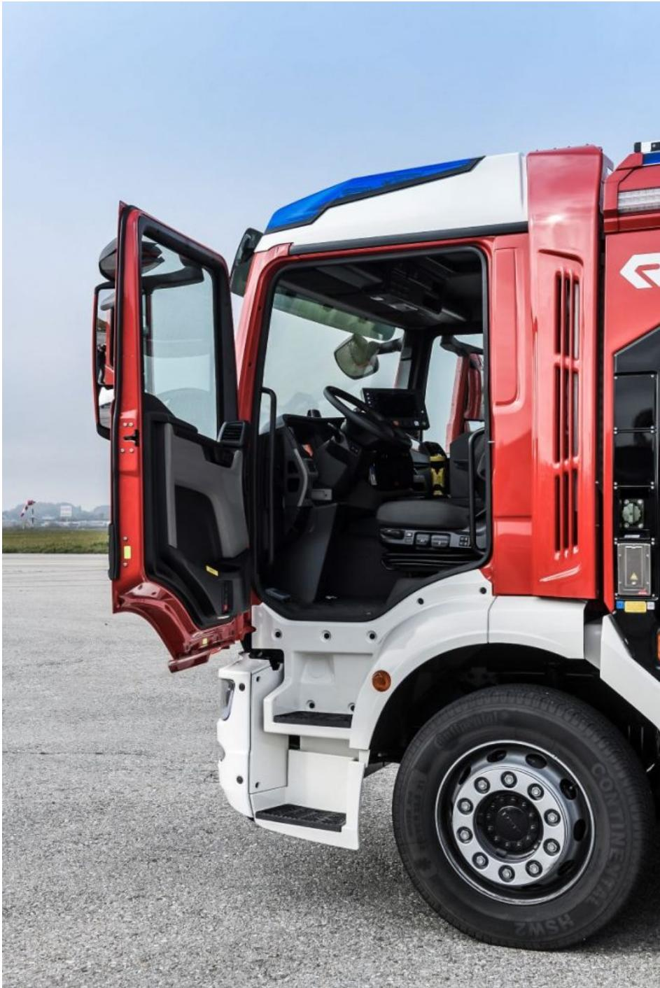
Bequemer Einstieg für den Maschinisten und Fahrzeugführer in die Fahrerhäuser der neuen MAN Truck-Generation, denn die Türen öffnen mit 89 Grad rechtwinklig. Gerade, übereinander angeordnete treppenartige Stufen und lange Handläufe in der Türöffnung tragen zur Sicherheit beim zügigen Ein- und Aussteigen bei (Bild: MAN Truck & Bus SE).
