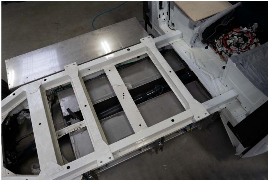
Der Einbau der Batterien auf Fahrgestellhöhe sorgt für eine sehr gute Straßenlage Bild: WAS).
