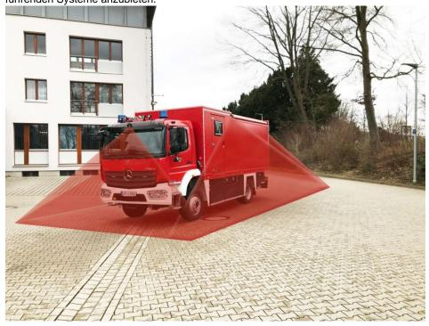
Das »iAVS«-System bietet eine 360°-Rundumsicht auf das Fahrzeug (Bild: Axion).
