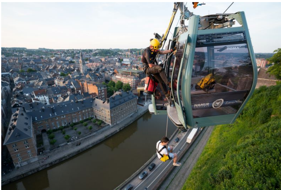
Evakuierung aus einer urbanen Seilbahn. Über ein Rettungsdreieck (Rettungsweste) kann die Person sicher abgeseilt werden (Bild: Namur, Belgien; Petzl).
