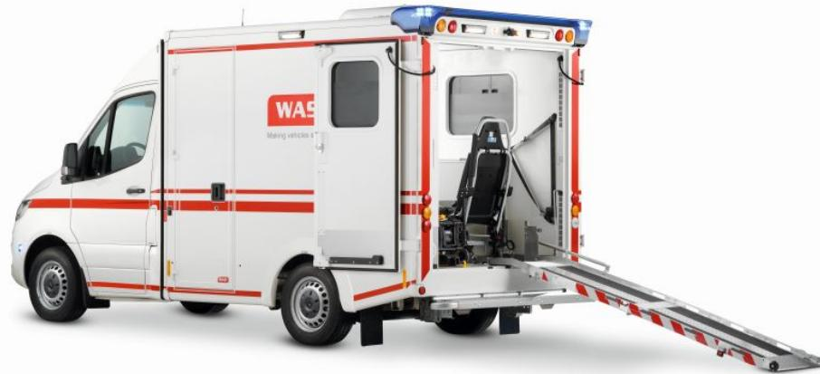
»WAS 500« KTW-Kofferaufbau auf Mercedes Benz Sprinter (Bild: WAS).
