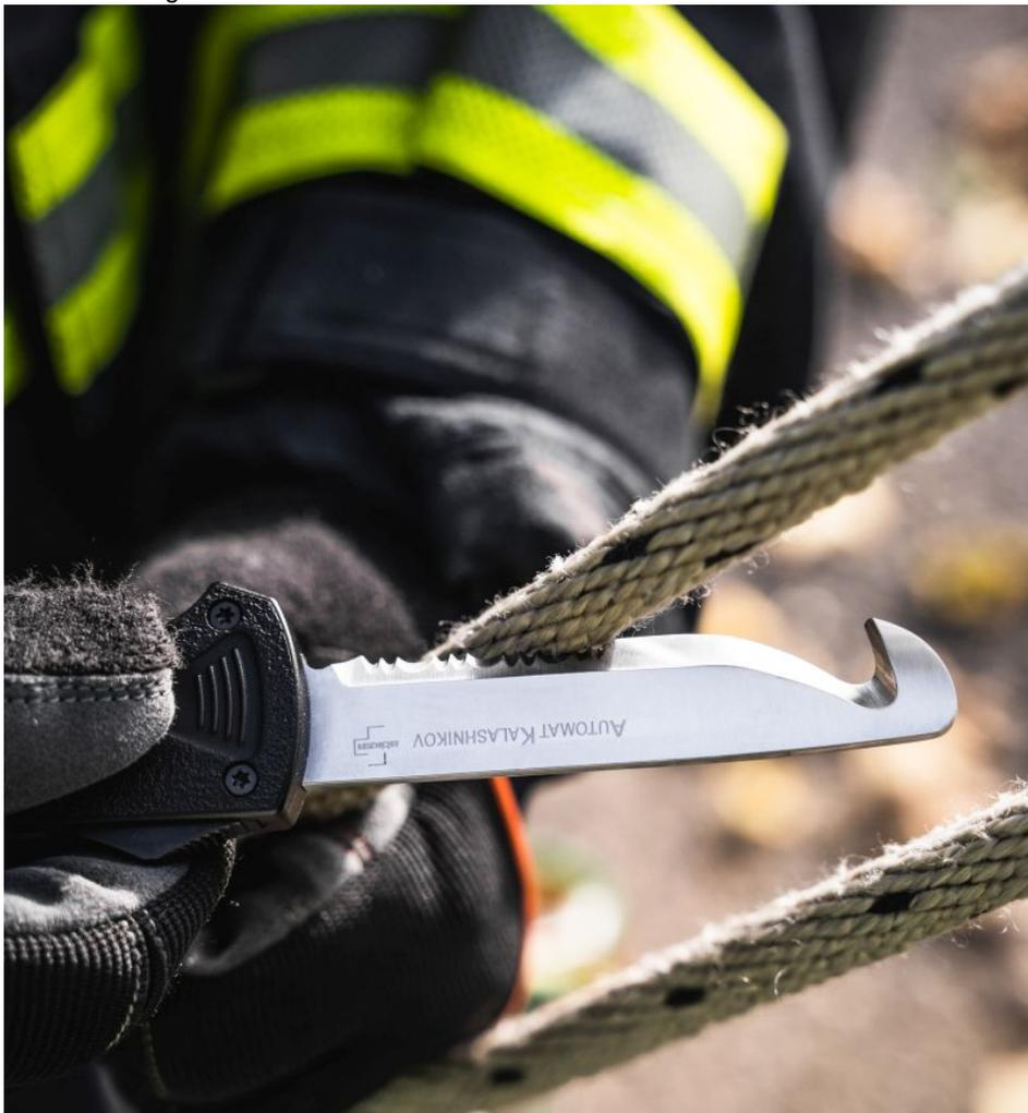
Der scharfe Wellenschliff des Messers ermöglicht auch das Trennen von dicken und verkrusteten Tauen (Bild: Böker).
