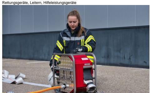
»HoseCleaner« reinigt verschmutzte Schläuche direkt an der Einsatzstelle (Bild: Barth).
