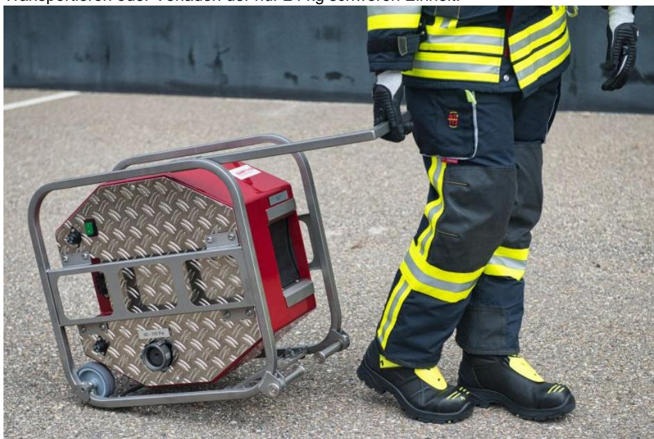
An dem stabilen Transportrahmen aus Edelstahl ist ein ausziehbarer Transportgriff angebracht (Bild: Barth).
