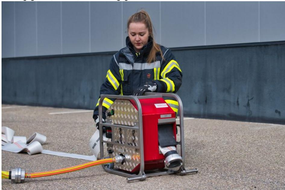
»HoseCleaner« reinigt verschmutzte Schläuche direkt an der Einsatzstelle (Bild: Barth).
