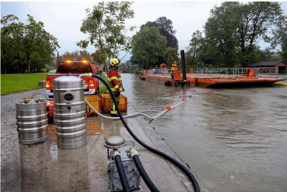
Der mobile Ölabscheider von Fladt wurde bereits beim Elbhochwasser erfolgreich eingesetzt. Im Vordergrund eine Pumpe des Herstellers ELRO (Bild: Fladt).
