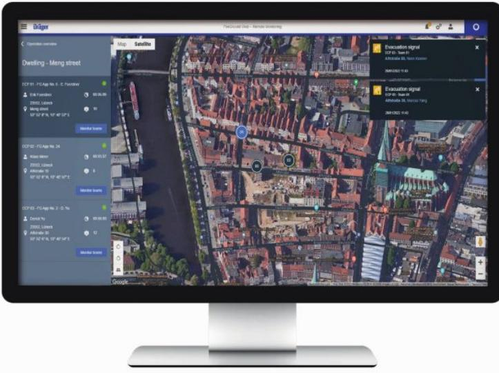
Über die optionale Web-Anwendung von Dräger »FireGround« ist eine Fernüberwachung, Berichterstellung und Datenauswertung des Einsatzes möglich.
