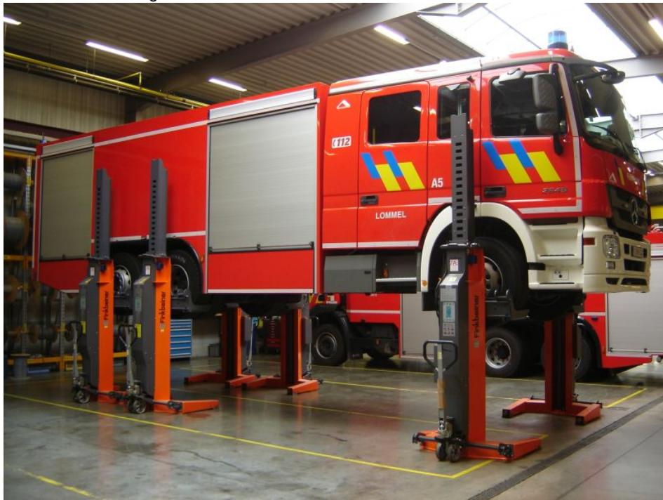
Die mobilen Radgreif-Hebeböcke »EHB« sind akkubetrieben und funkfern gesteuert. Nach der Nutzung können sie schnell und platzsparend zur Seite geschoben werden (Bild: Walter Finkbeiner).
