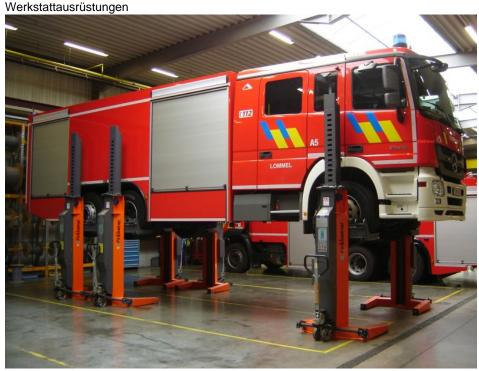
Die mobilen Radgreif-Hebeböcke »EHB« sind akkubetrieben und funkferngesteurt. Nach der Nutzung können sie schnell und platzsparend zur Seite geschoben werden (Bild: Walter Finkbeiner).
