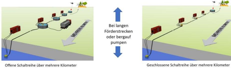
Ob in offener oder geschlossener Reihenschaltung für die Wasserförderung über extrem lange Förderwegstrecken oder zur drastischen Verkürzung von Pendelzeiten von z. B. TLF oder Heli: Auch hier beweist sich das Hytrans-System als ein schnelles, flexibles und äußerst effizientes Wasser-Management-System.
