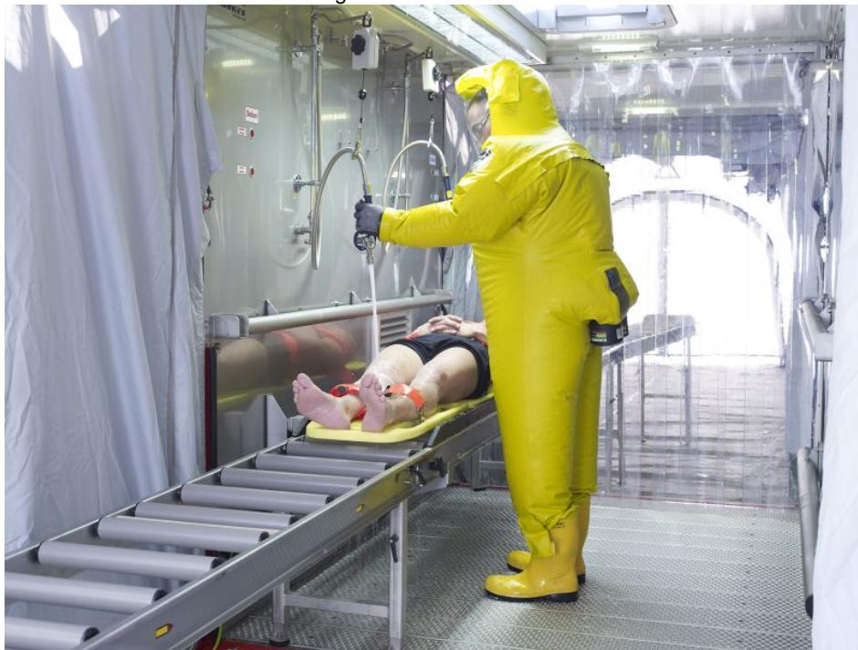
Beispielsweise für Chemieunfälle bietet Gemco spezielle Container mit »Waschstraßen« an (Bild: Gemco).
