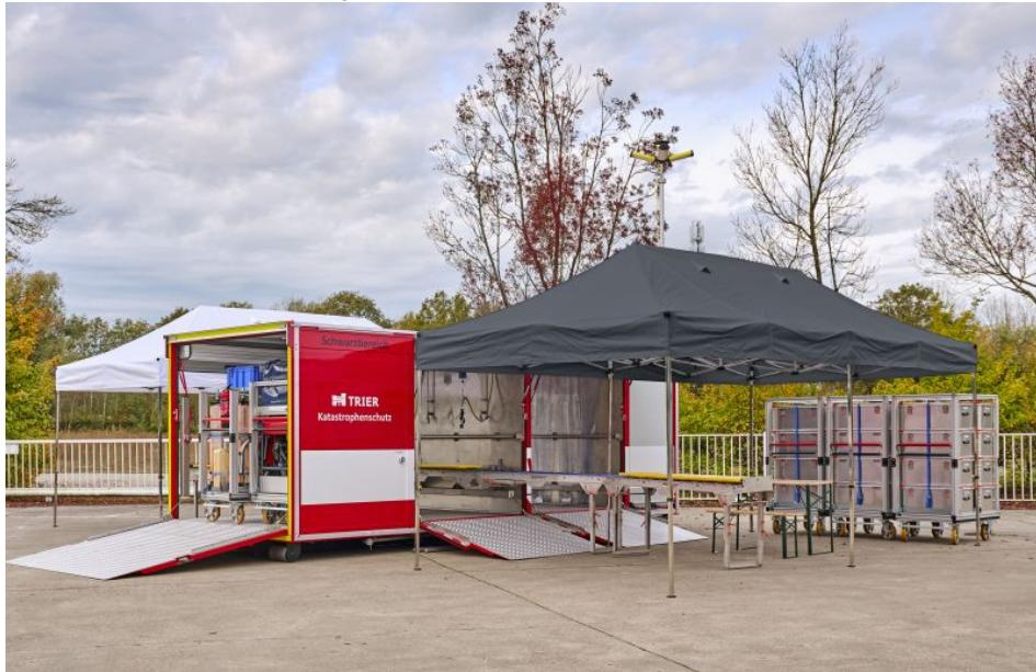
Dekon-Abrollcontainer der FW Trier für den Schwarzbereich (Bild: Gemco).
