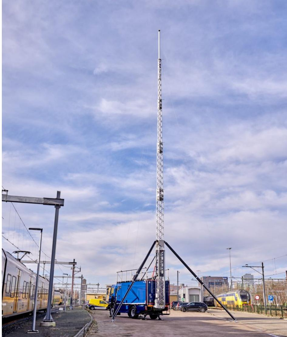
Das Messfahrzeug ist mit einem 30 m hohen Teleskopmast ausgestattet, auf dem verschiedene Antennen platziert sind (Bild. Gemco).
