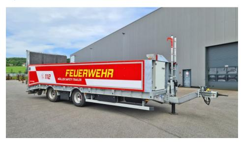
Der »Müller Safety Trailer« ist ein wasserdichter, oben geöffneter Lkw-Multifunktionsanhänger mit hydraulischer Auffahrrampe. Er ist unter anderem einsetzbar für den Transport größerer Lasten, von Fahrzeugen oder kontaminierten Einsatzmaterialien (Bild: Paul Müller).
