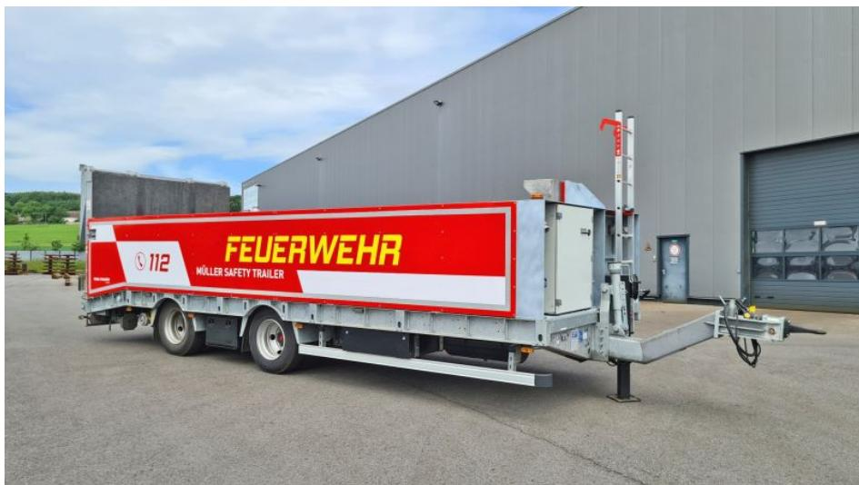
Der »Müller Safety Trailer« ist ein wasserdichter, oben geöffneter Lkw-Multifunktionsanhänger mit hydraulischer Auffahrrampe. Er ist unter anderem einsetzbar für den Transport größerer Lasten, von Fahrzeugen oder kontaminierten Einsatzmaterialien (Bild: Paul Müller).
