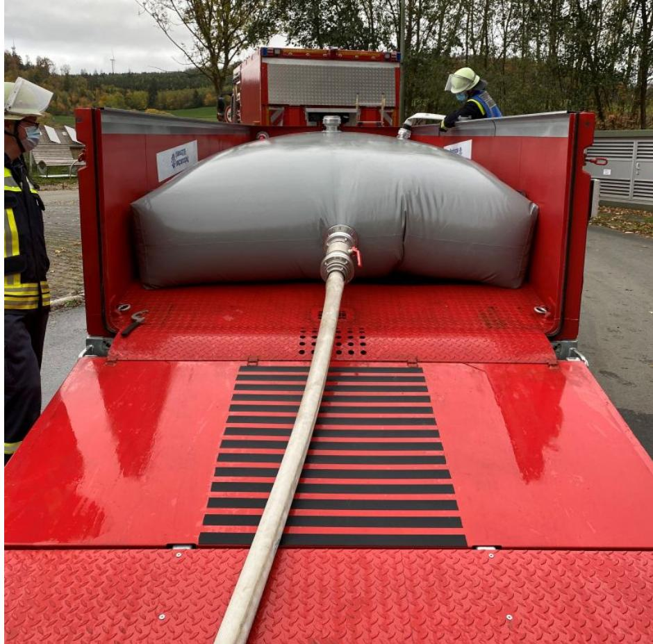
Ansicht eines gefüllten Wassersacks im »Safety Trailer«. Abgebildet ist ein Modell mit 7000 Liter Fassungsvermögen (Bild: Paul Müller).
