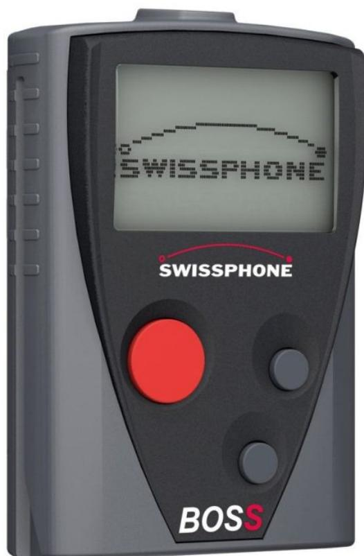
Der »RES.Q«-Meldeempfänger sichert eine schnelle Rückmeldung über IoT-Mobilfunktechnik und Hybridalarmierung über LTE Cat M1 (Bild: Swissphone).
