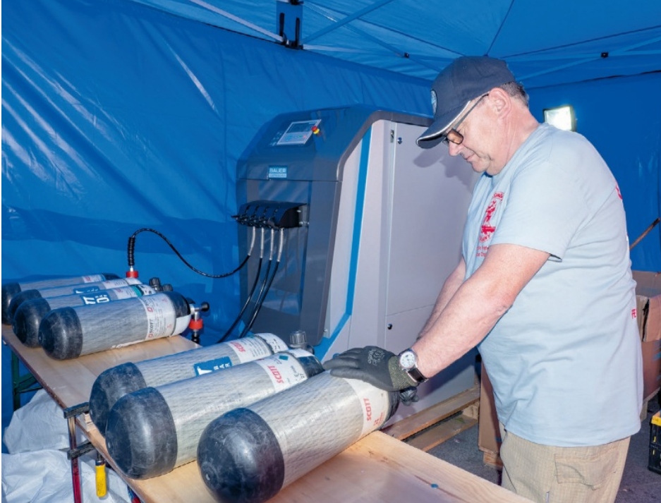
Atemluftkompressor »VERTICUS« im Einsatz beim Firefighting Combat Challenge in Berlin (Bild: Ralf Deichelmann).
