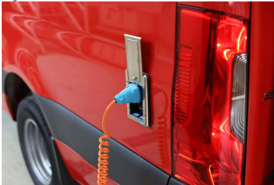
Die Außeneinspeisung ist für eine umgehende Einsatzbereitschaft konzipiert und trennt sich beim Starten des Motors automatisch (Bild: bott).
