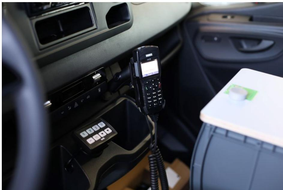
Zur installierten Elektronik zählen ein Funkgerät, Innen- und Außenbeleuchtung, eine zusätzliche Batterie, Steckdosen sowie eine Rückfahrkamera (Bild: bott).
