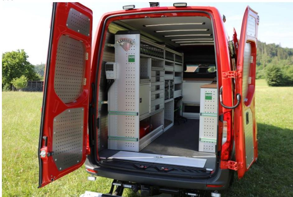
Der große Regalaufbau auf der Beifahrerseite enthält Schubladen, »bottBoxen«, »Systainer<sup>3</sup>«-Koffer und Ablagefächer (Bild: bott).
