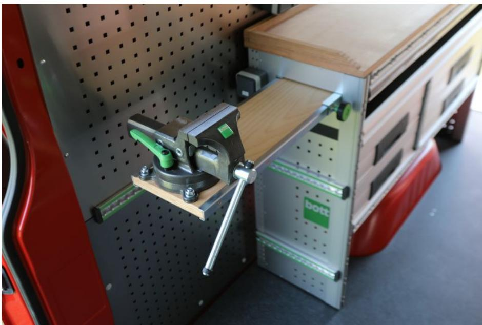
Unterhalb der zur Schiebetür hin ausziehbaren Werkbank mit Schraubstock sollen Gasflaschen verzurrt werden (Bild: bott).
