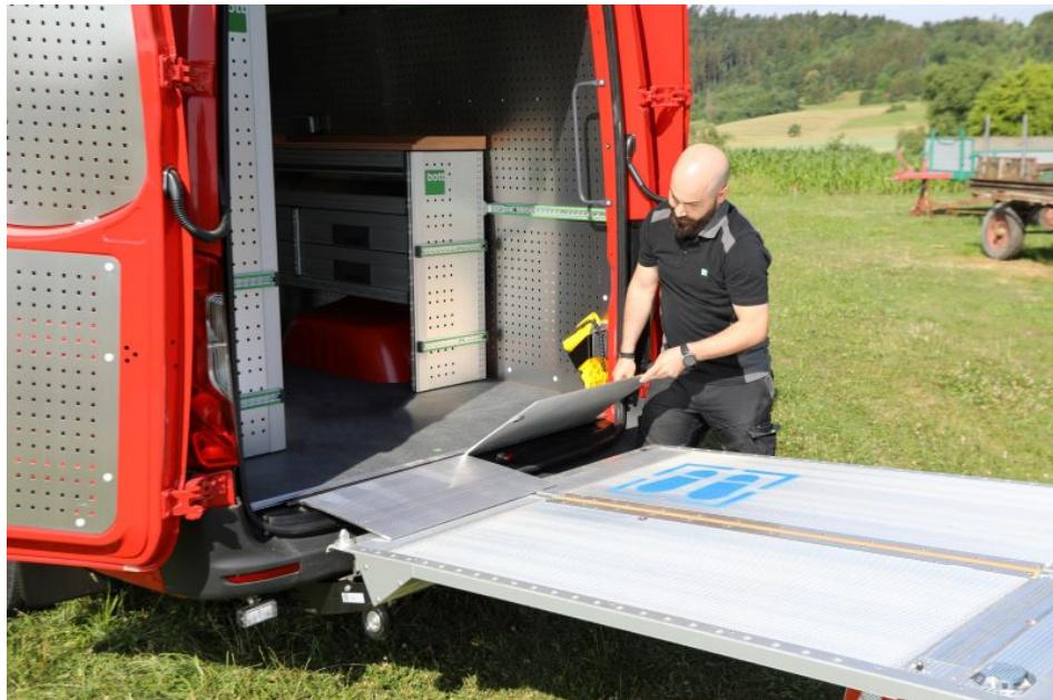
Um schweres wartungsbedürftiges Gerät leicht ein- und ausladen zu können, ist das Fahrzeug mit einer Ladebordwand ausgestattet (Bild: [bott](#)).
