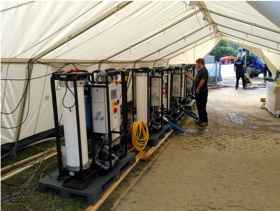
Trinkwassernotversorgung im Ahrtal (Bild: Kärcher Futuretech).
