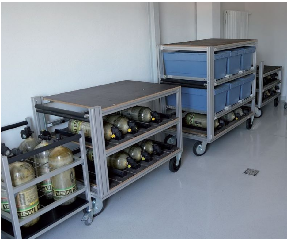
Rollcontainer von MiniTec dienen zur Lagerung der Flaschen für den Schwarzbereich (Bild: Air Base Ramstein).
