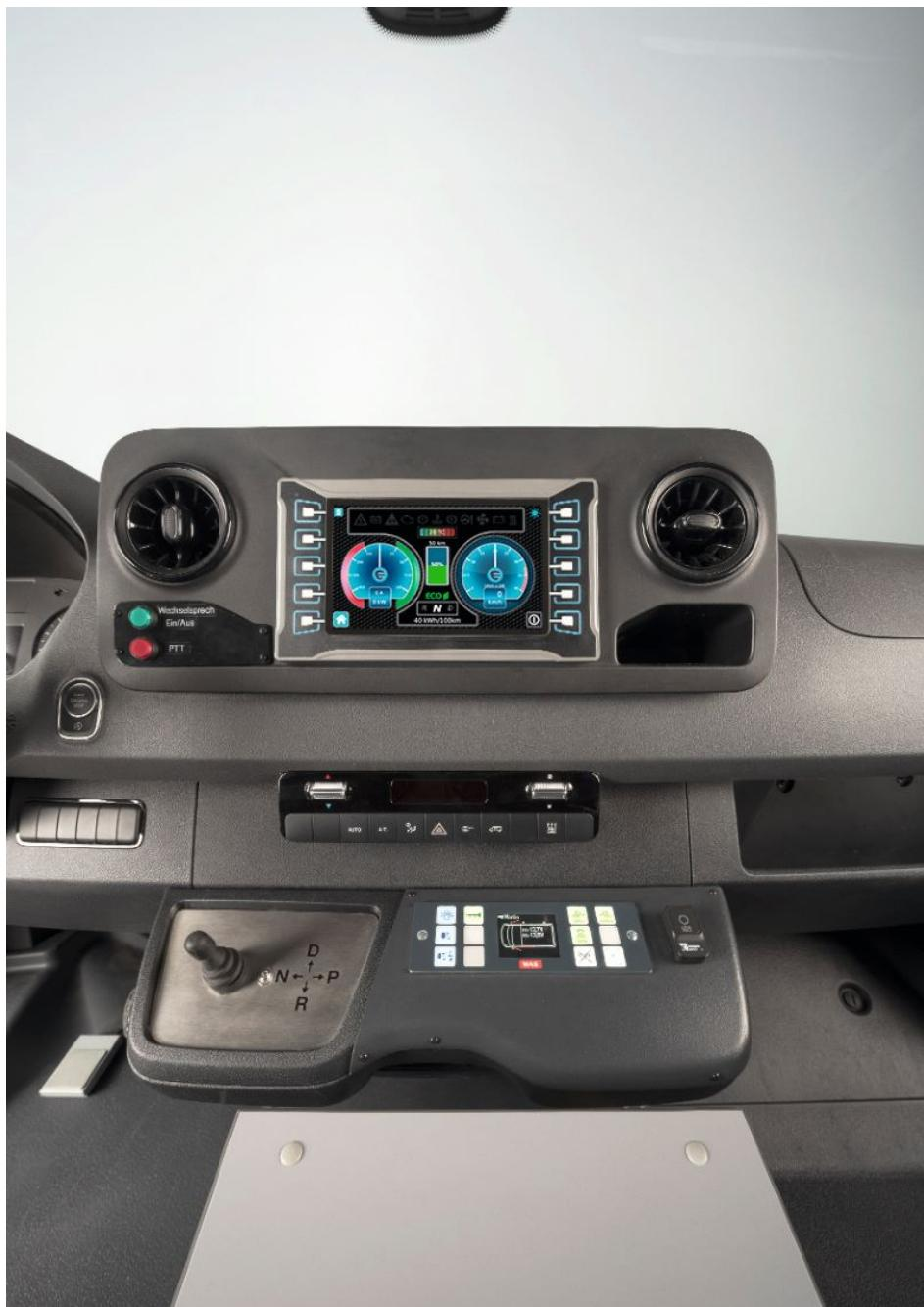
Im Cockpit wird der Batterieladestand visualisiert und die noch verfügbare Strecke angezeigt (Bild: WAS).
