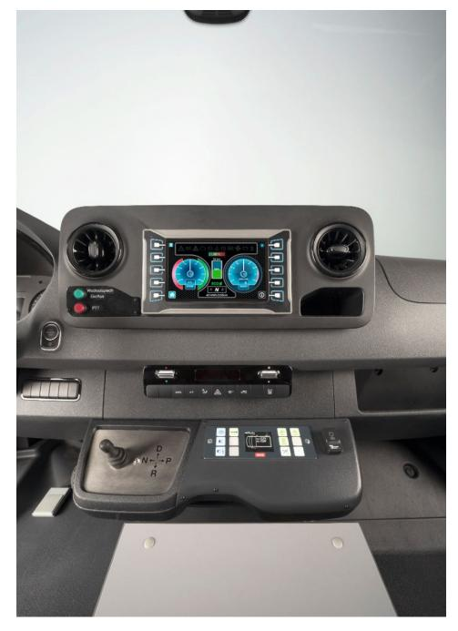
Im Cockpit wird der Batterieladestand visualisiert und die noch verfügbare Strecke angezeigt (Bild: WAS).
