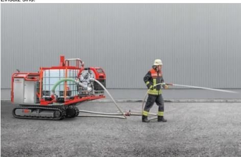
Mit dem Add-On Waldbrandsatz lassen sich nicht nur Brände im unwegsamen Forstgelände kraft- und personalsparend löschen. Auch schweres Gerät der Feuerwehr kann so schnell und sicher transportiert werden (Bild: Suffel).
