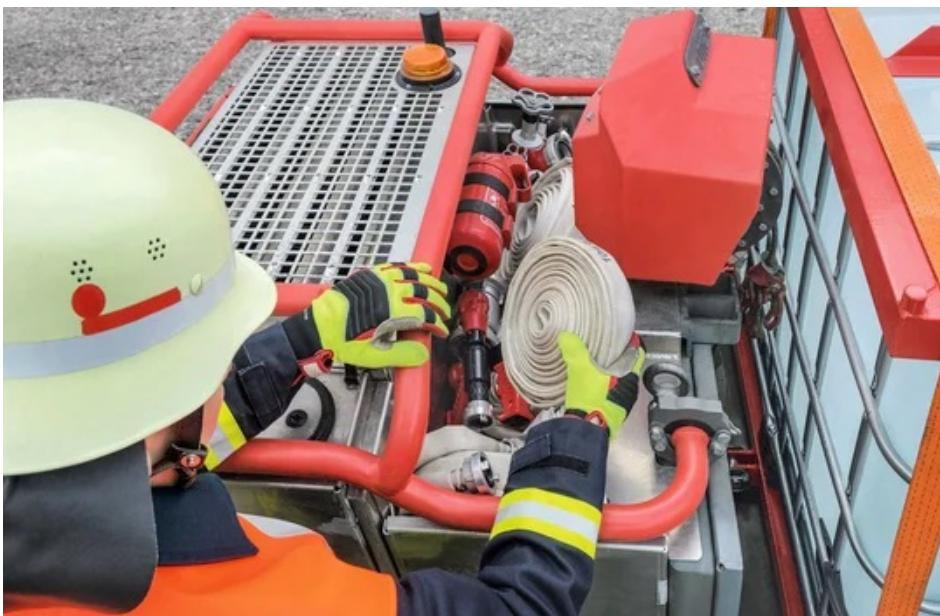
Jede am Markt verfügbare Feuerlöschpumpe kann auf dem »SmartSkidder« befestigt und transportiert werden (Bild: Suffel).
