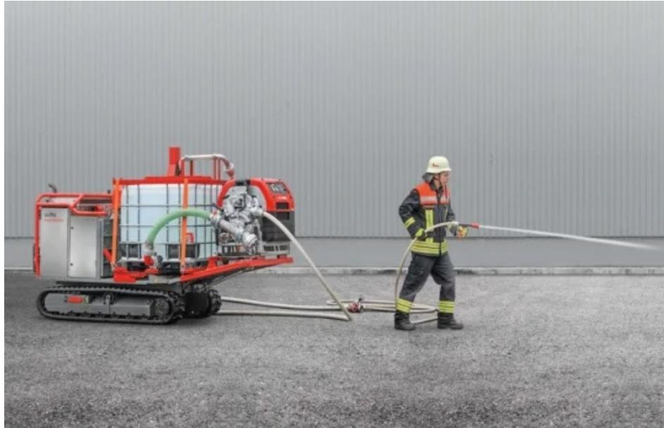
Mit dem Add-On Waldbrandsatz lassen sich nicht nur Brände im unwegsamen Forstgelände kraft- und personalsparend löschen. Auch schweres Gerät der Feuerwehr kann so schnell und sicher transportiert werden (Bild: Suffel).
