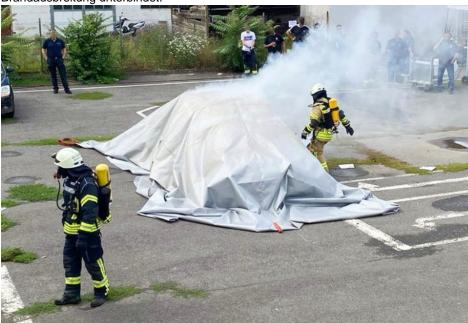
Als Löschdecke eingesetzt werden konventionelle Brände schnell erstickt. Einen E-Brand hält sie unter der Decke und minimiert so die Schäden an der Umgebung.
