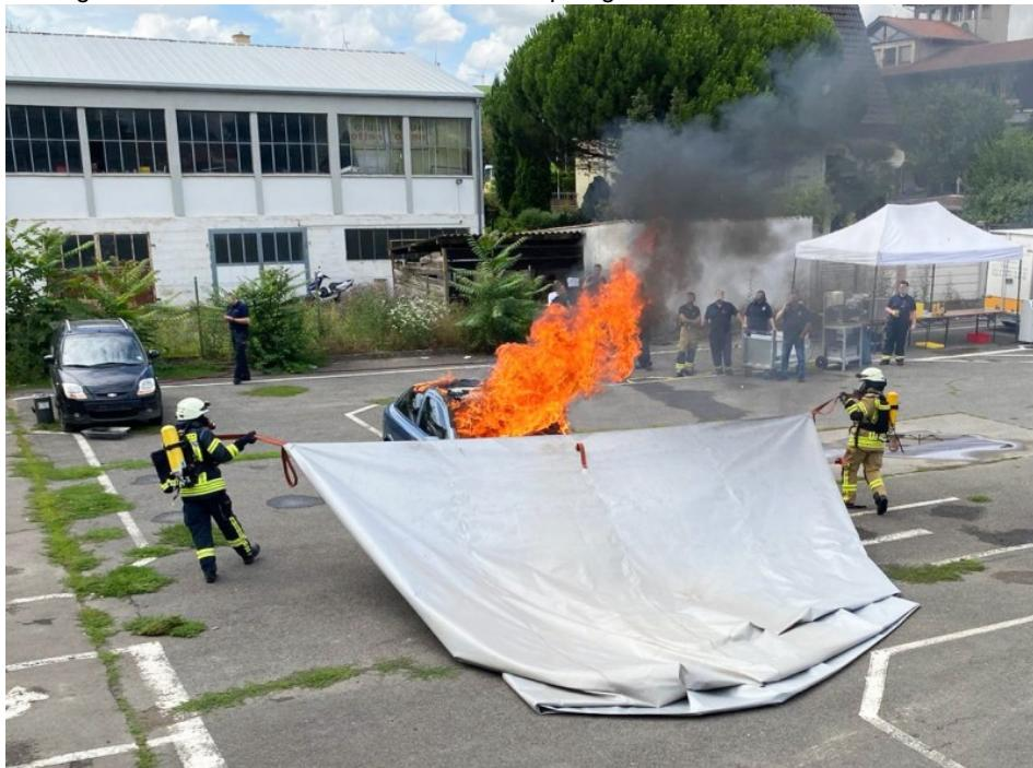
Das Spezial-Glasfasergewebe mit einer beidseitigen Silikonbeschichtung der Brandbegrenzungsdecke hält über längere Zeit Temperaturen bis 1000 °C stand, in Spitzen sogar 1300 °C (Bild: rescue-tec).
