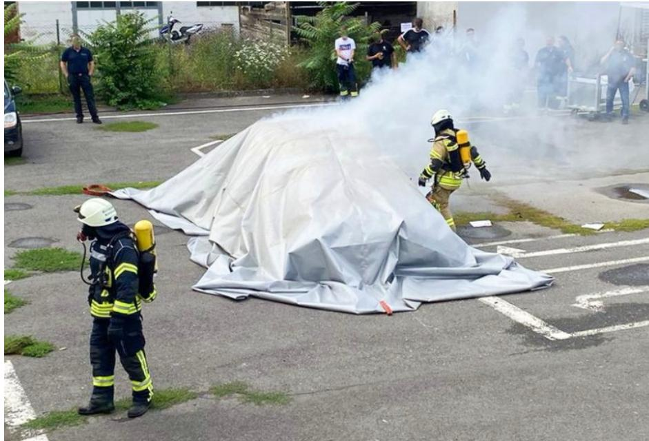
Als Löschdecke eingesetzt werden konventionelle Brände schnell erstickt. Einen E-Brand hält sie unter der Decke und minimiert so die Schäden an der Umgebung.
