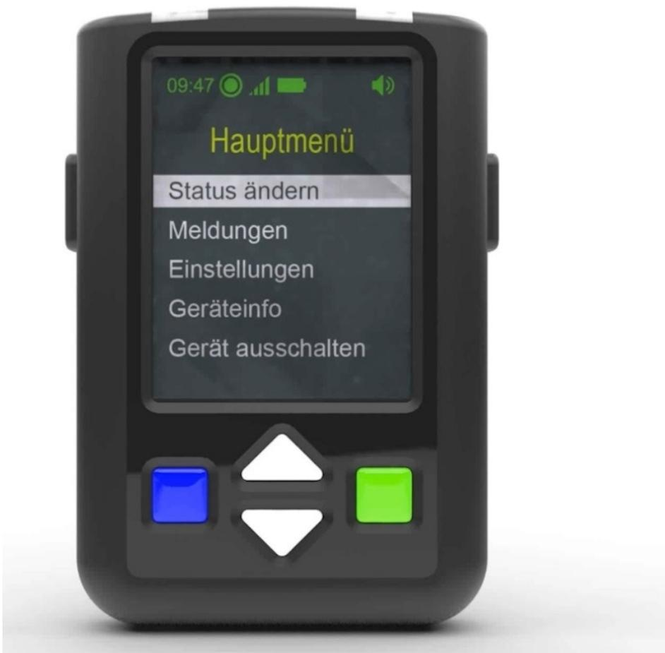
Der Pager »F.R.E.D.« kommuniziert nicht mehr über GPRS, sondern über das moderne LTE CAT M1 Netz (Bild: HK.SYSTEMS).
