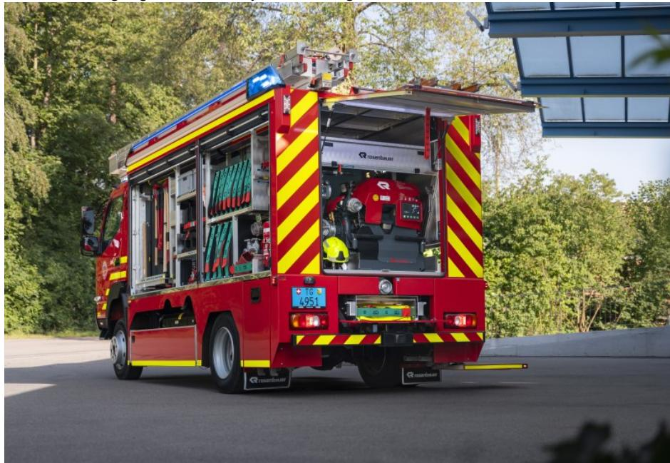
Neben der Tragkraftspritze im Heck ist auch eine Ausrüstung zur Bekämpfung kleinerer Waldbrände an Bord (Bild: Daimler).
