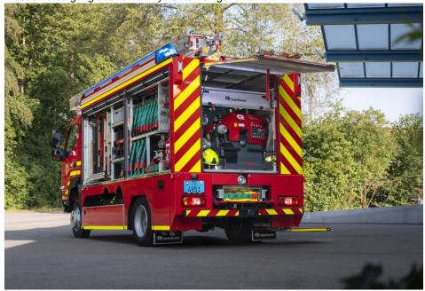
Neben der Tragkraftspritze im Heck ist auch eine Ausrüstung zur Bekämpfung kleinerer Waldbrände an Bord (Bild: Daimler).
