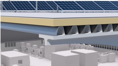
Die Brandgefahr, der »PVProtect« entgegen wirkt, lauert häufig im Dach: Brennbare Dämmstoffe und Trapezbleche fördern die Ausbreitung von Bränden (Bild: Minimax).
