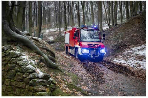
Mit Allrad-Antrieb und einer Reifendruckregelanlage ausgestattet eignet sich das Fahrzeug besonders dazu, auch in unwegsames Gelände vordringen zu können.
