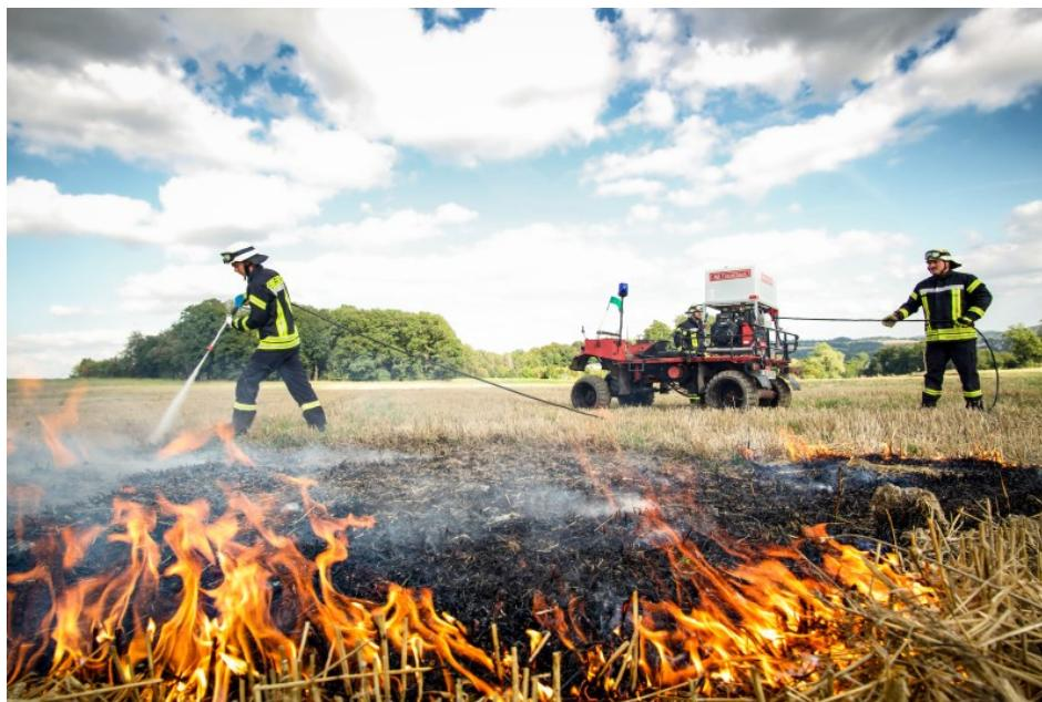
Aufgrund des hohen Drucks ist »Fast Attack« ideal zur Moorbrandbekämpfung oder überall dort zu nutzen, wo Schmelzbrände mit dem normalen Strahlrohr schlecht zu erreichen sind.
