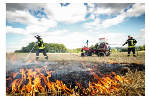
Aufgrund des hohen Drucks ist »Fast Attack« ideal zur Moorbrandbekämpfung oder überall dort zu nutzen, wo Schwelbrände mit dem normalen Strahlrohr schlecht zu erreichen sind.
