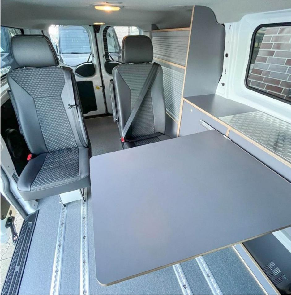
Der »Smartfloor« Aluminium-Systemboden ermöglicht die unterschiedlichsten Bestuhlungsmöglichkeiten (Bild: AMF Bruns).
