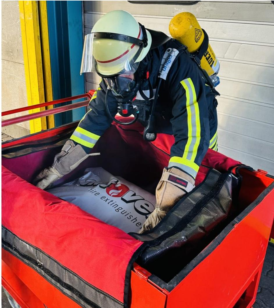
Effiziente Löschmethode: Ein kompletter Sack Trocken-Löschenmittel wird einfach auf das Havariegut gelegt (Bild: Paul Müller).
