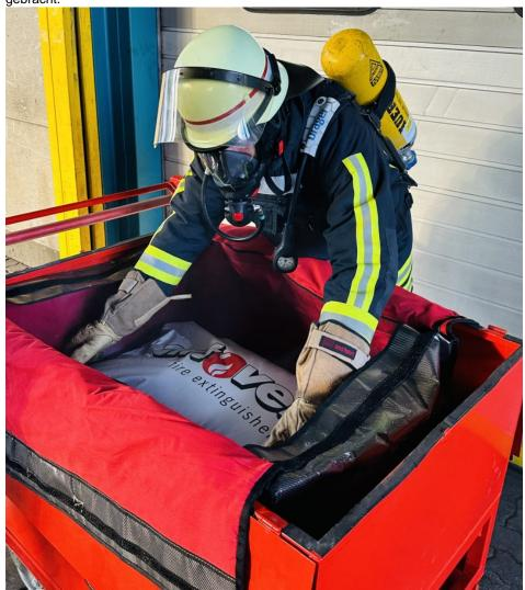
Effiziente Löschmethode: Ein kompletter Sack Trocken-Löschmittel wird einfach auf das Havariegut gelegt (Bild: Paul Müller).
