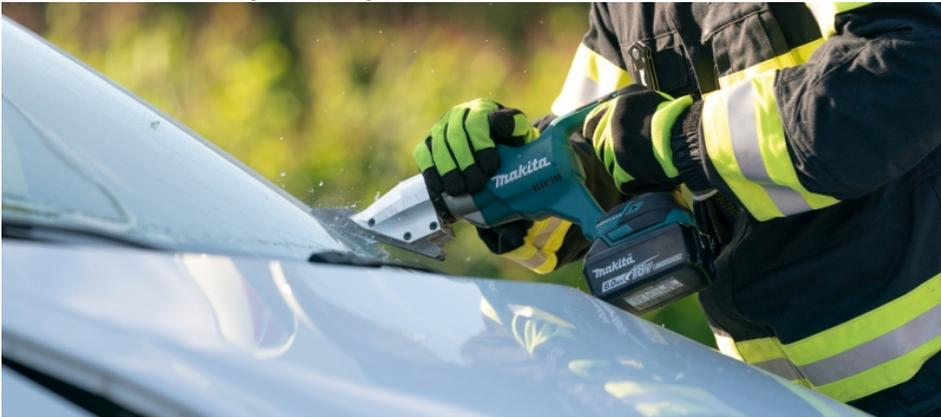
Die neue Akku-Faserzementschere ermöglicht einen schnellen Zugang über die Front- oder Heckscheibe eines Pkws (Bild: Makita).
