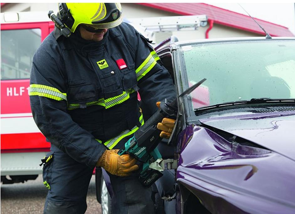
Die leistungsfähige Akku-Reciprosäge ist für funkenfreies und spurstabiles Trennen von Metall bestens geeignet. Die Hubhöhe beträgt 20 mm (Bild: Makita).
