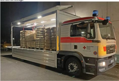
Die Gerätewagen mit Schwenkwandaufbau für seitliche Gabelstapler-Beladung sind im Katastrophenfall sehr flexibel einsetzbar (Bild: Ewers).
