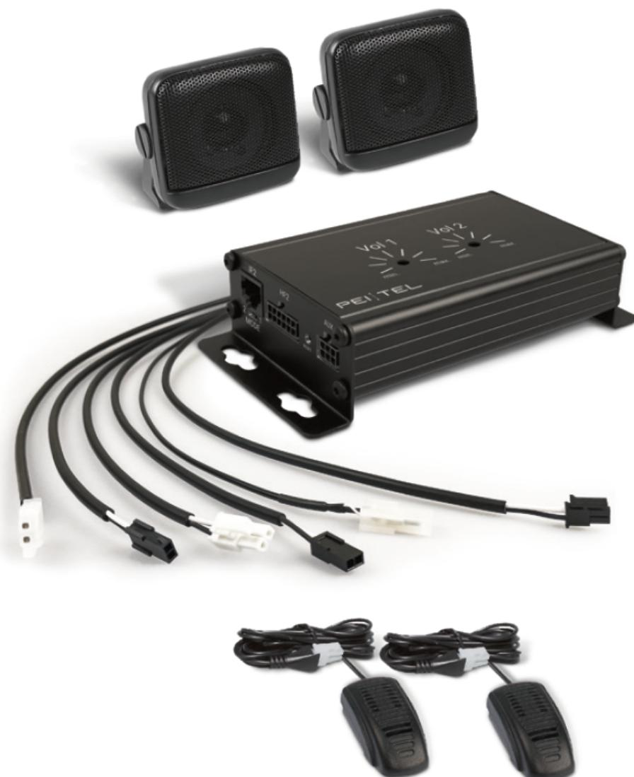
Bei »PTIntercom« können die einzelnen Komponenten beliebig an den relevanten Stellen im Fahrzeug angebracht und je nach Bedarf nach dem Baukastenprinzip mit passendem Audiozubehör ergänzt werden (Bild: [pei tel](#)).
